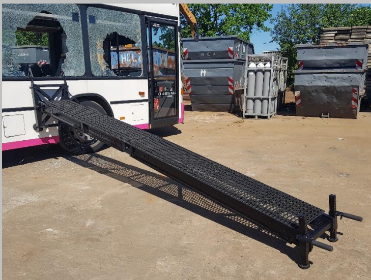
4-Meter-Rampe frontal im Bus eingehängt
