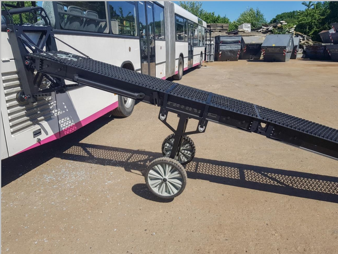
Rampe mit Radwagen eingehängt
