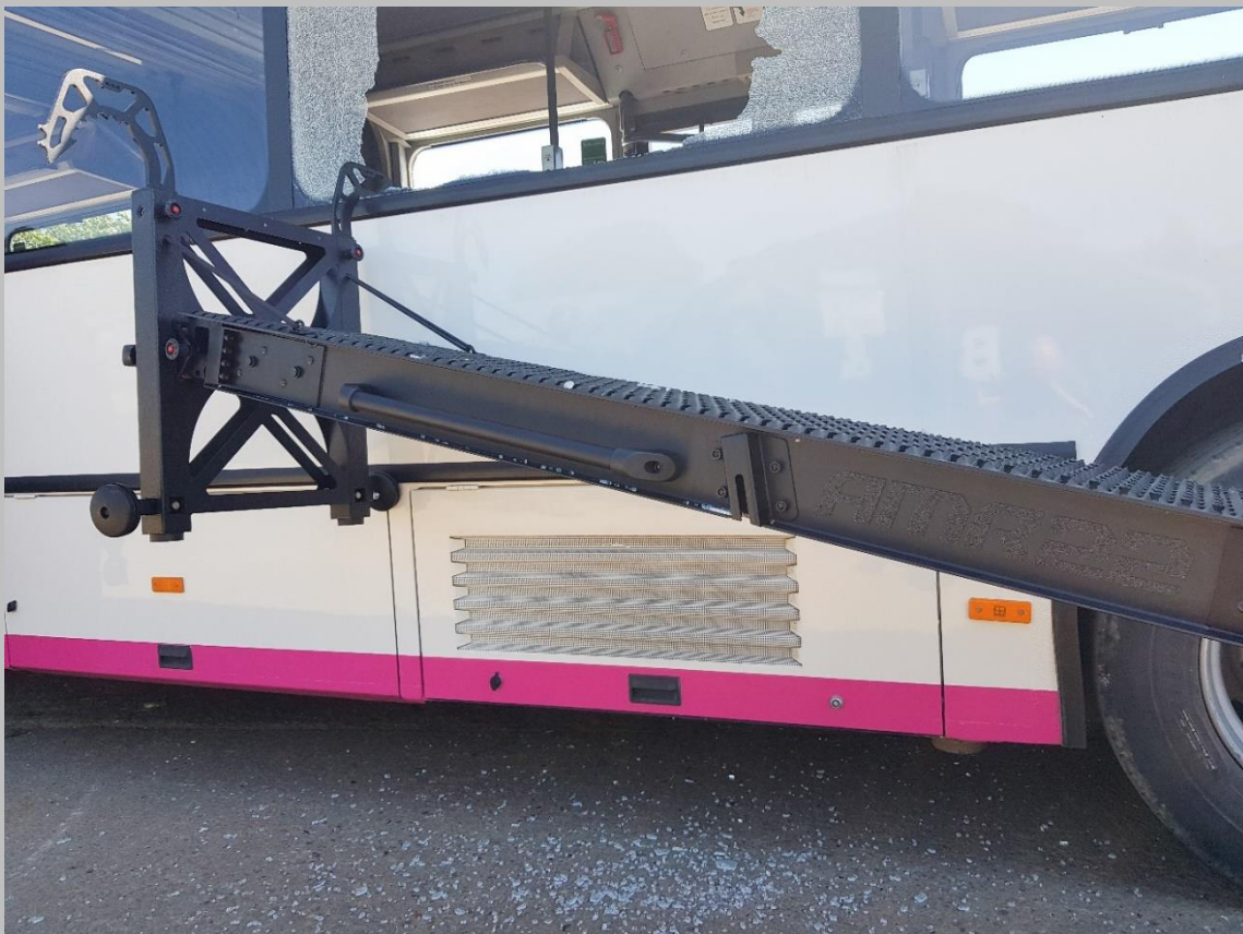
Rampe seitlich im Bus eingehängt
