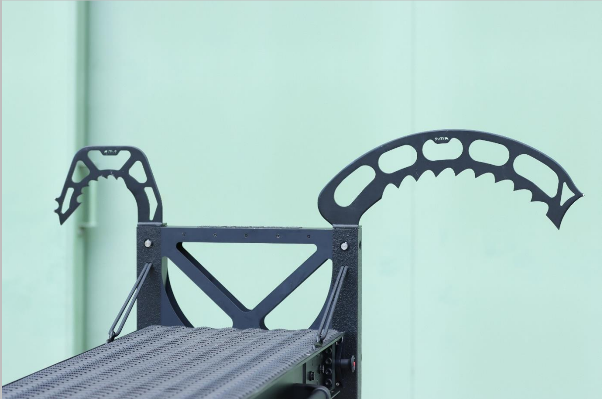
Kleiner (Bus, Bahn) und großer Haken (Fenster, Balkone, Dächer)
